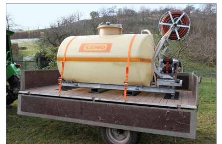
Ladungssicherung mit Antritschmatte und Zurrgurten (Niederzurren) am Beispiel eines Mobilien Bewässerungssystems 2000 Liter
