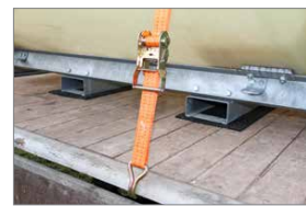
Ladungssicherung mit Antritschmatte und Zurrgurten (Niederzurren) am Beispiel eines Mobilien Bewässerungssystems 2000 Liter
